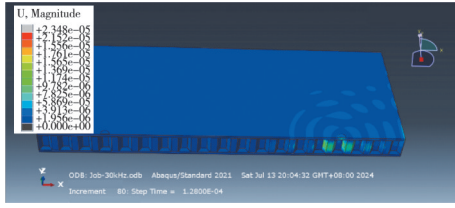
图14 中心频率 f_c = 30 kHz时的位移快照
