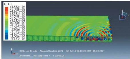
图15 中心频率 f_c = 100 kHz时的位移快照
